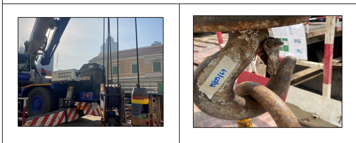
ภาพที่ 78 การตรวจสอบระบบเบรก Limit Switch สลิง เชือก อุปกรณ์การยก
